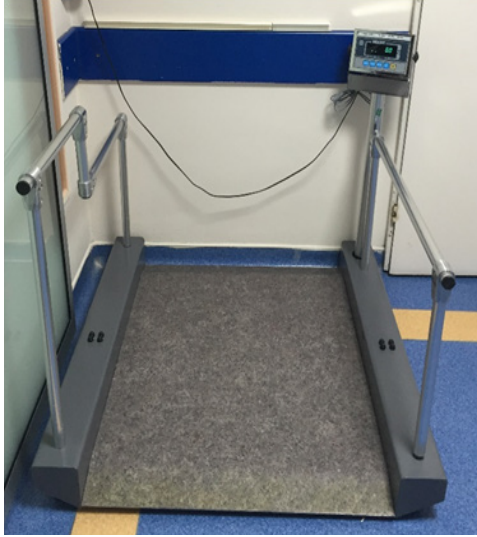
Şekil 1. Süper obez hastaların kullanımına uygun yüksek kapasiteli baskül
